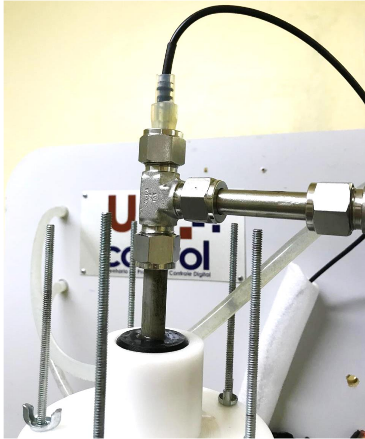
Figura 13 – Topo da coluna com adaptador em Tê metálico.
