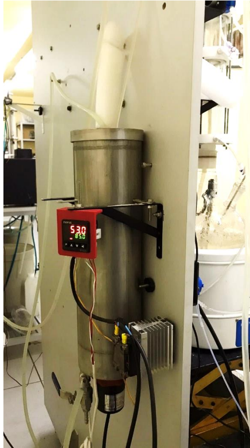
Figura 16 – Sistema de banho térmico da solução de alimentação.
