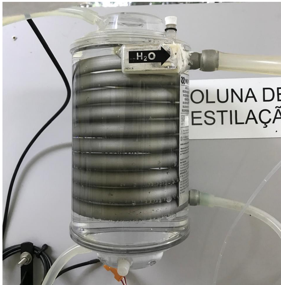
Figura 12 – Condensador do tipo serpentina na coluna de destilação.
