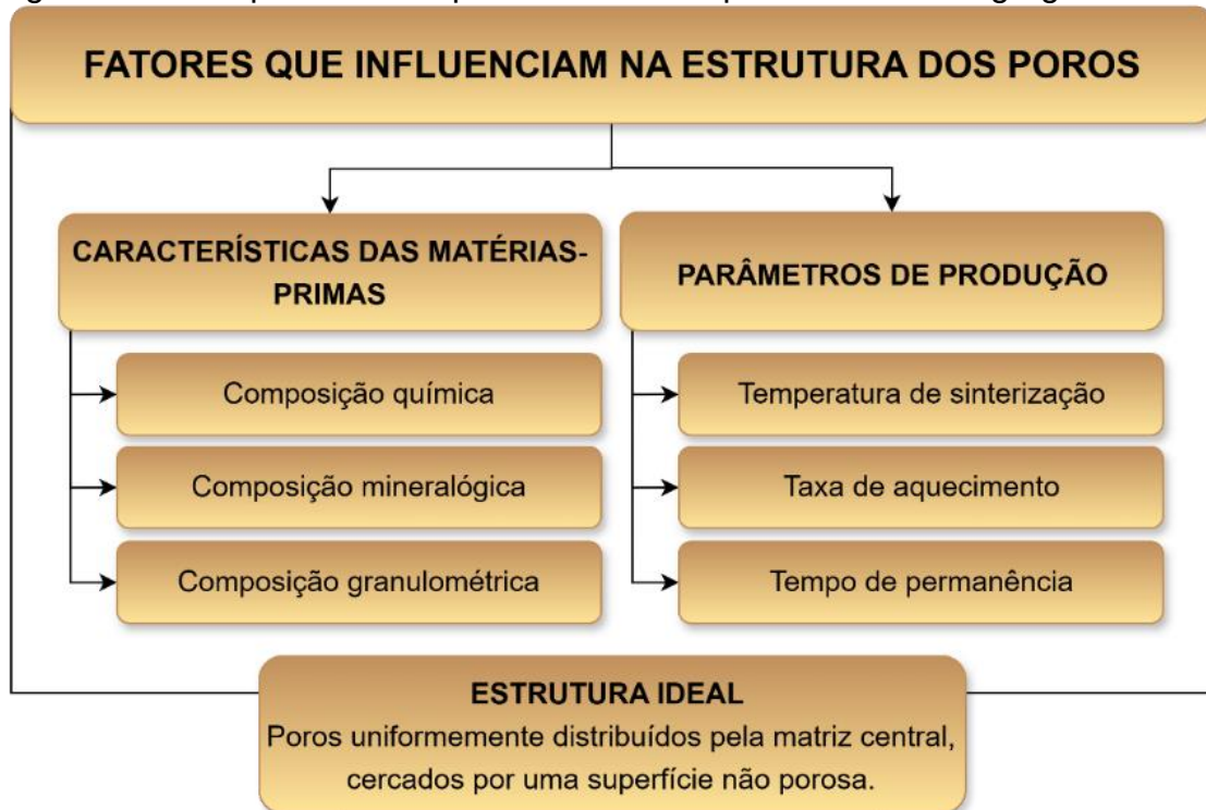
Figura 3 – Principais fatores que interferem na porosidade dos agregados leves.
