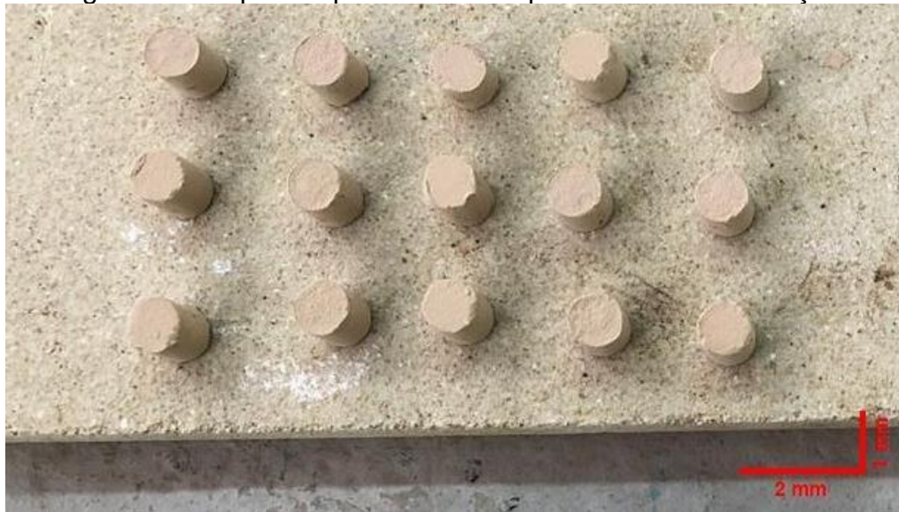
Figura 7 – Corpos de prova antes do processo de sinterização.
