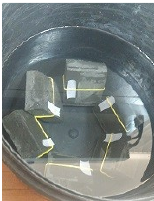
Figura 21: Ensaio de absorção de água com tijolos imersos por 24 horas
