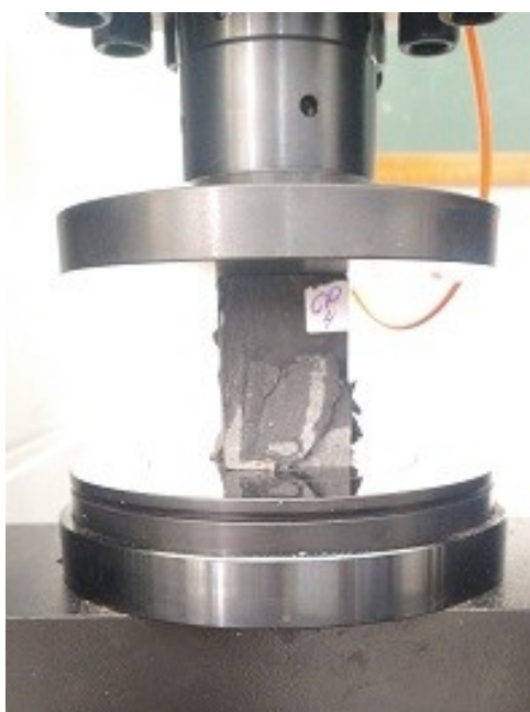
Figura 32: Compósito sendo testado à compressão.
