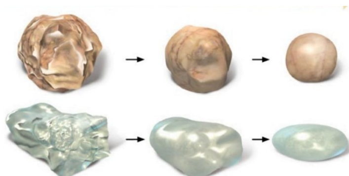
Figura 7: Morfologia das partículas conforme desgaste: angulares (esquerda), polimórficas (meio) e esféricas (direita).
