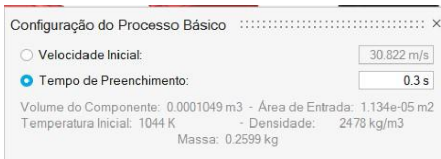
Figura 3.10 – velocidade inicial e tempo de preenchimento utilizados na simulação
