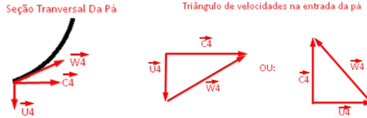
Figura 8. Representação das velocidades e do triângulo de velocidades na entrada da pá da turbina. Fonte (Autor).
