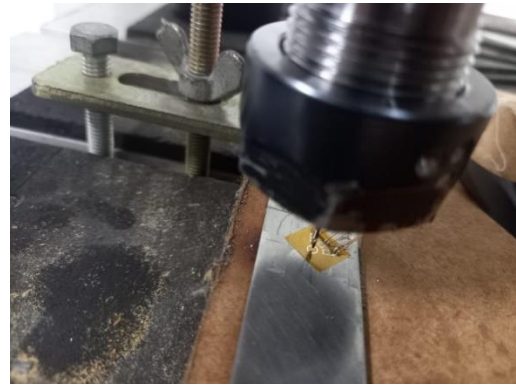
b) Usinagem do furo passante na chapa com a roseta instrumentada.
