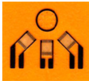
Figura 10. Modelo geométrico da roseta (Adaptado de Excel Sensores).
