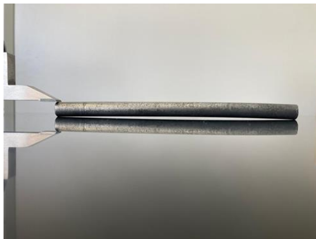
Figura 4. Amostra após têmpera sobre base de granito retificada.
