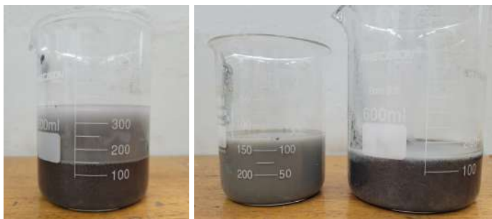
Figura 5: Resíduo magnético combinado e decantado com álcool etílico. Fonte: Autor.
