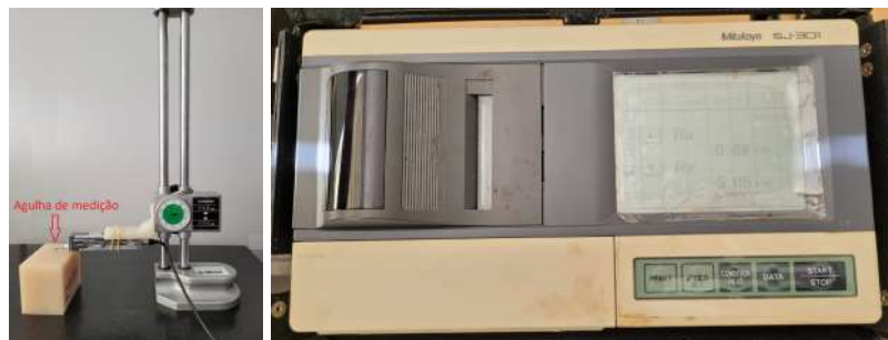
Figura 7: Rugosímetro Mitutoyo SJ-30. Fonte: Autor.
