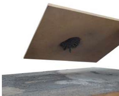
Figura 2: Procedimento para Separação Magnética utilizando ímã. Fonte: Autor.
