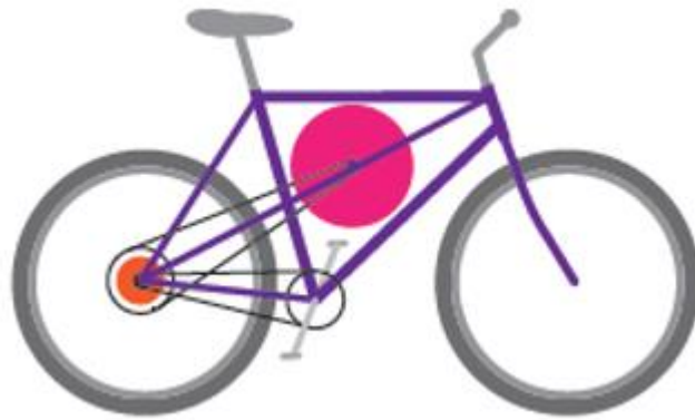
Figura 5. Conceito de Ludlum de KERS para bicicleta (Ludlum, 2013).
