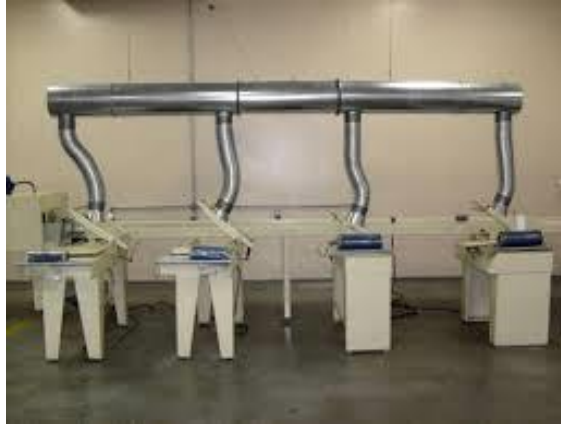
Figura 3: Dutos para condução de ar (Soluções industriais, 2017).
