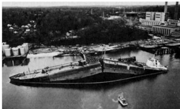
Figura 1. Exemplo de fratura frágil, em um navio de Callister (2011).
