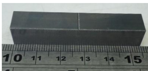
Figura 7. Usinagem do corpo de prova para o ensaio Charpy.
