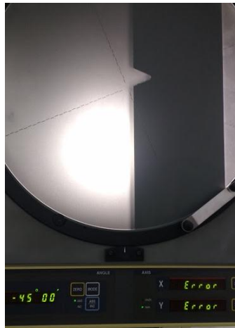
Figura 8. Verificação do ângulo do entalhe no projetor de perfil.
