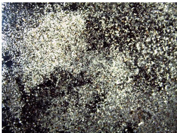
Figura 15: Tamanho de partícula obtido na atomização a água com pressão de 100 MPa. (Aumento de 40x)
