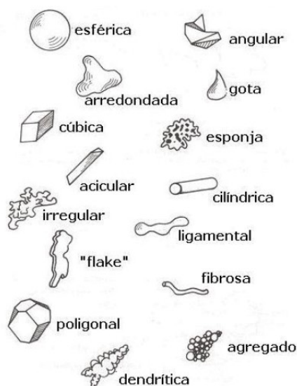
Figura 14: Esquema ilustrativo da morfologia das partículas produzidas através de atomização [14].
