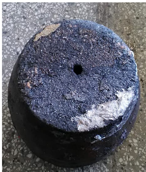
Figura 8: Cadinho com orifício igual a 6 mm de diâmetro.
