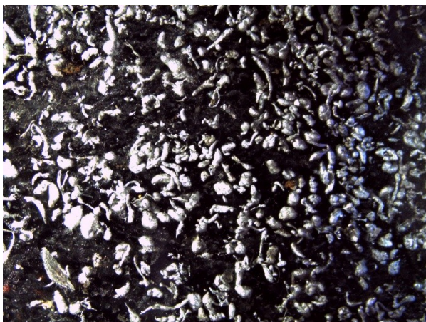
Figura 8: Tamanho de partícula obtido na atomização a gás com pressão de 0,4 MPa. (Aumento de 40x)
