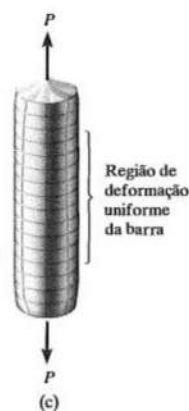
Figura 2: Cargas axiais ( P ) tracionando uma barra e causando deformação uniforme (Fonte: Hibbeler, 2009).
