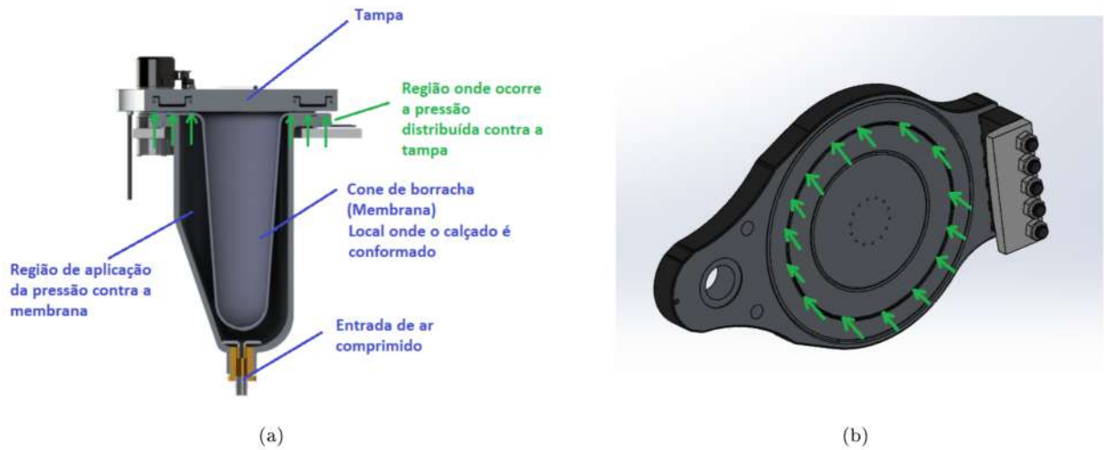
Figura 10: Esquema do sistema de prensagem da máquina (a) e distribuição das forças na tampa da prensa (b).
