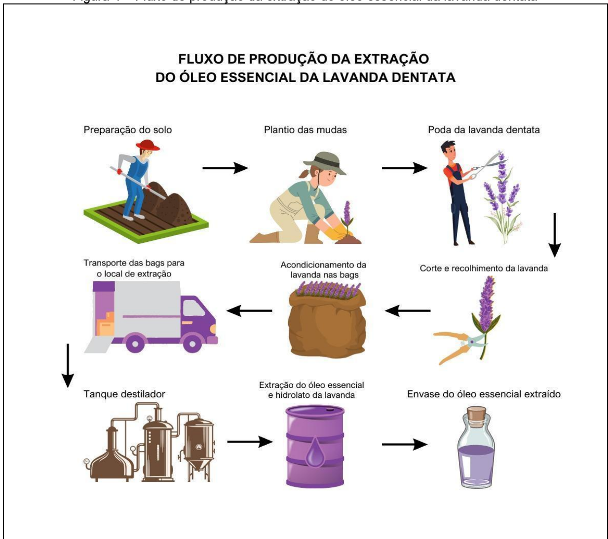
Figura 4 – Fluxo de produção da extração do óleo essencial da lavanda dentata
