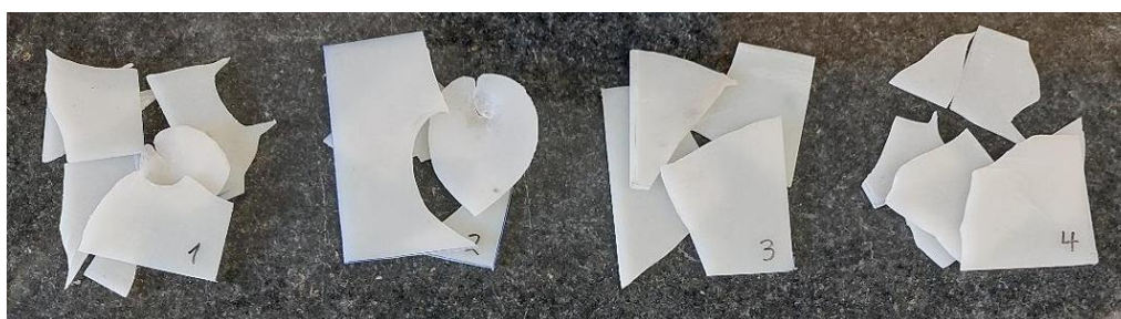
Figura 22. Corpos de prova do PELBD-R após o ensaio de resistência ao Impacto por Queda de Dardo.
