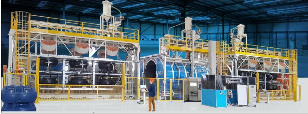
Figura 3. Máquina de rotomoldagem para multicamadas (30).
