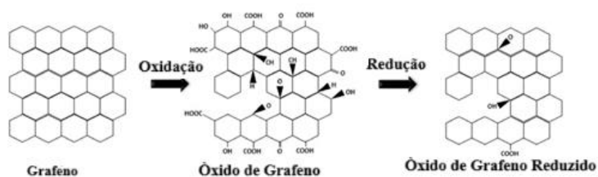
Figura 6. Representações das estruturas do grafeno, óxido de grafeno e óxido de grafeno reduzido, respectivamente (35).
