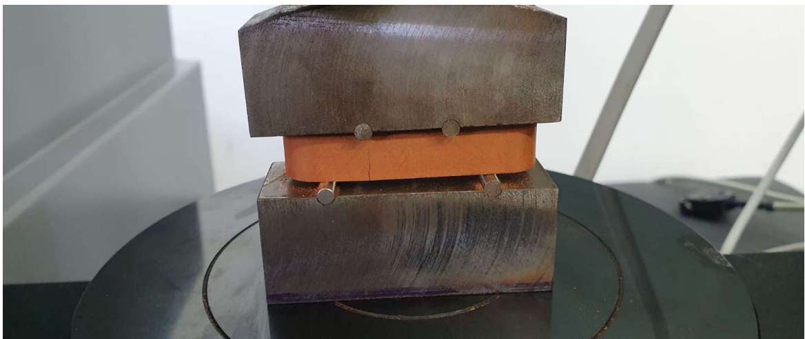
Figura 6 – Dispositivo para ensaio de resistência mecânica por flexão a 4 pontos. No detalhe, ruptura na amostra.
