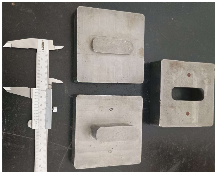
Figura 4 – Matriz utilizada para conformação dos tijolos.
