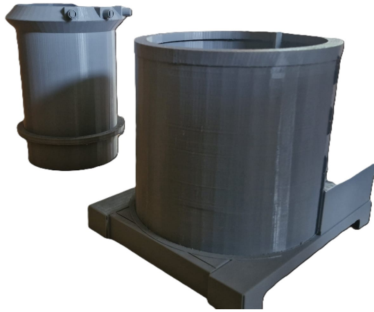
Figura 10: Máquinas em Escala construídas com manufatura aditiva. Fonte: autores.
