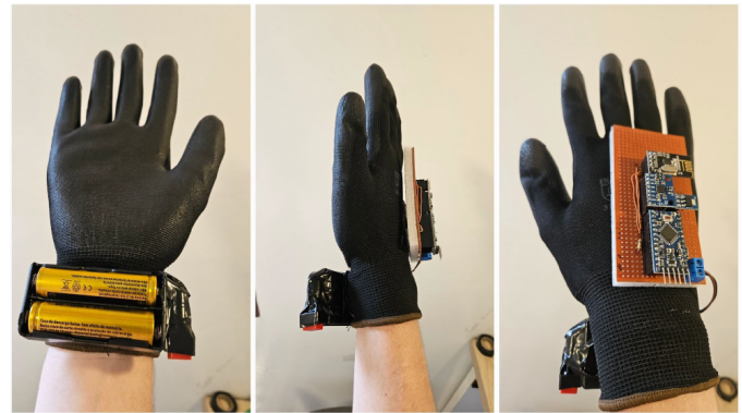
Figura 7. Luva sensorizada. Adaptado de: "Desenvolvimento de uma luva para captura de gestos com comunicação sem fio." [18]
