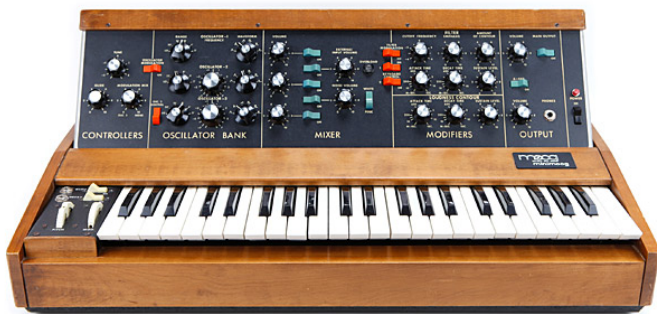
Figura 3. Sintetizador MiniMoog. Adaptado de: www.teclacenter.com.br [19]
