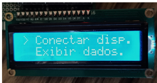
Figura 20. Tela inicial do menu exibida no display LCD, com opções de navegação destacando “Conectar disp.” e “Exibir dados”.
