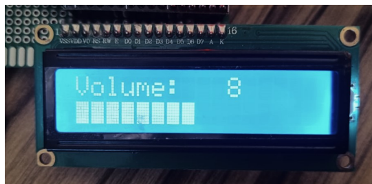
Figura 21. Tela de ajuste de volume, com barra gráfica correspondente ao nível 8.
