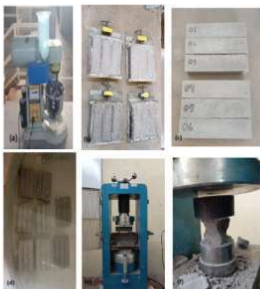
Figura 3: Processo de obtenção dos corpos de prova: Preparação da argamassa (a), moldagem dos corpos de prova (b), corpos de prova desmoldados (c), cura dos corpos de prova (d), rompimento dos corpos de prova a compressão (e) e corpo de prova rompido (f).
