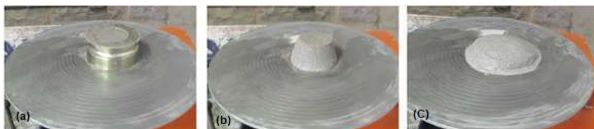
Figura 4: Etapas do ensaio de consistência: Enchimento do cone (a), amostra antes do ensaio (b), amostra após ensaio (c), conforme NBR16541(2016).
