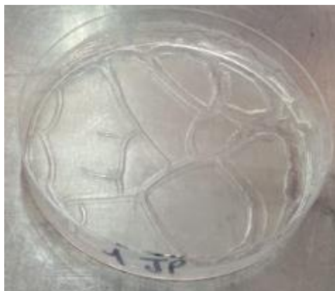
Figura 7 – Imagem ilustrativa de um filme produzido no teor de 6% do óleo de melaleuca estudado (calculado em base seca de amido)
