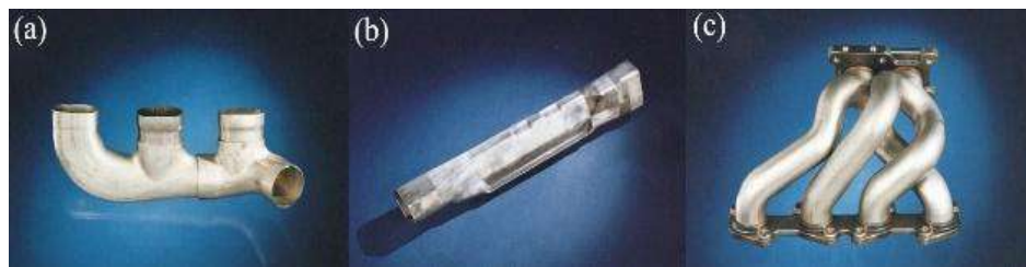
Figura 3 – Hidroconformação por : (a) expansão/compressão pura, (b) expansão/compressão e calibração local, (c) calibração pura.
