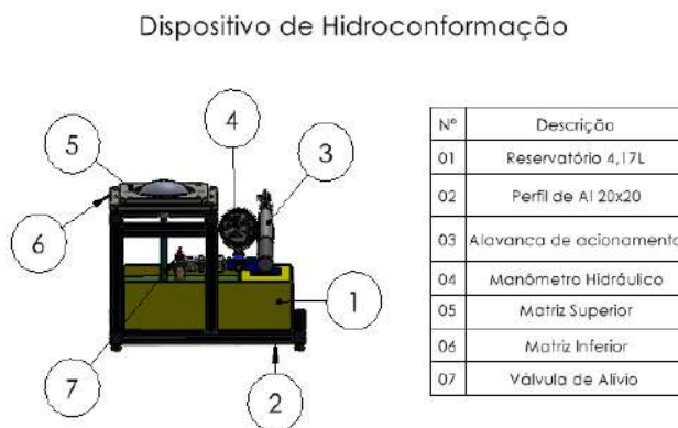
Figura 11 – Partes e peças do dispositivo de hidroconformação.
