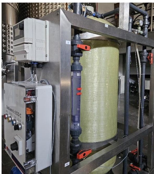
Figura 14: Equipamento de troca catiônica, Stabymatic ECO C.
