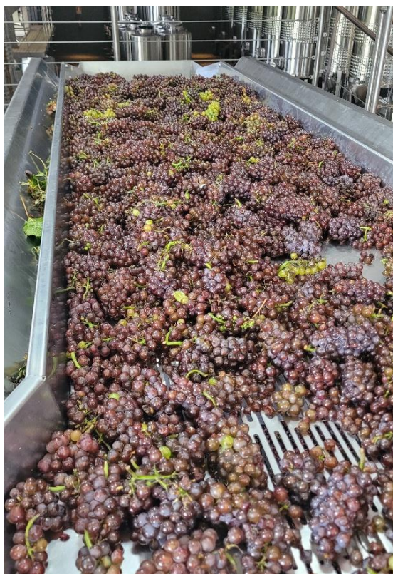
Figura 3: Uvas sobre a esteira vibratória para a seleção de cachos.
