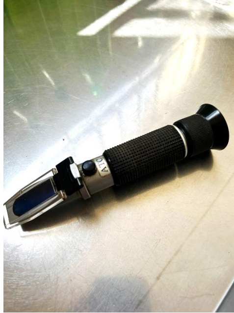
Figura 2: Refratômetro Analógico utilizado na safra 2024 na IVAL para medir o grau Babo das uvas.
