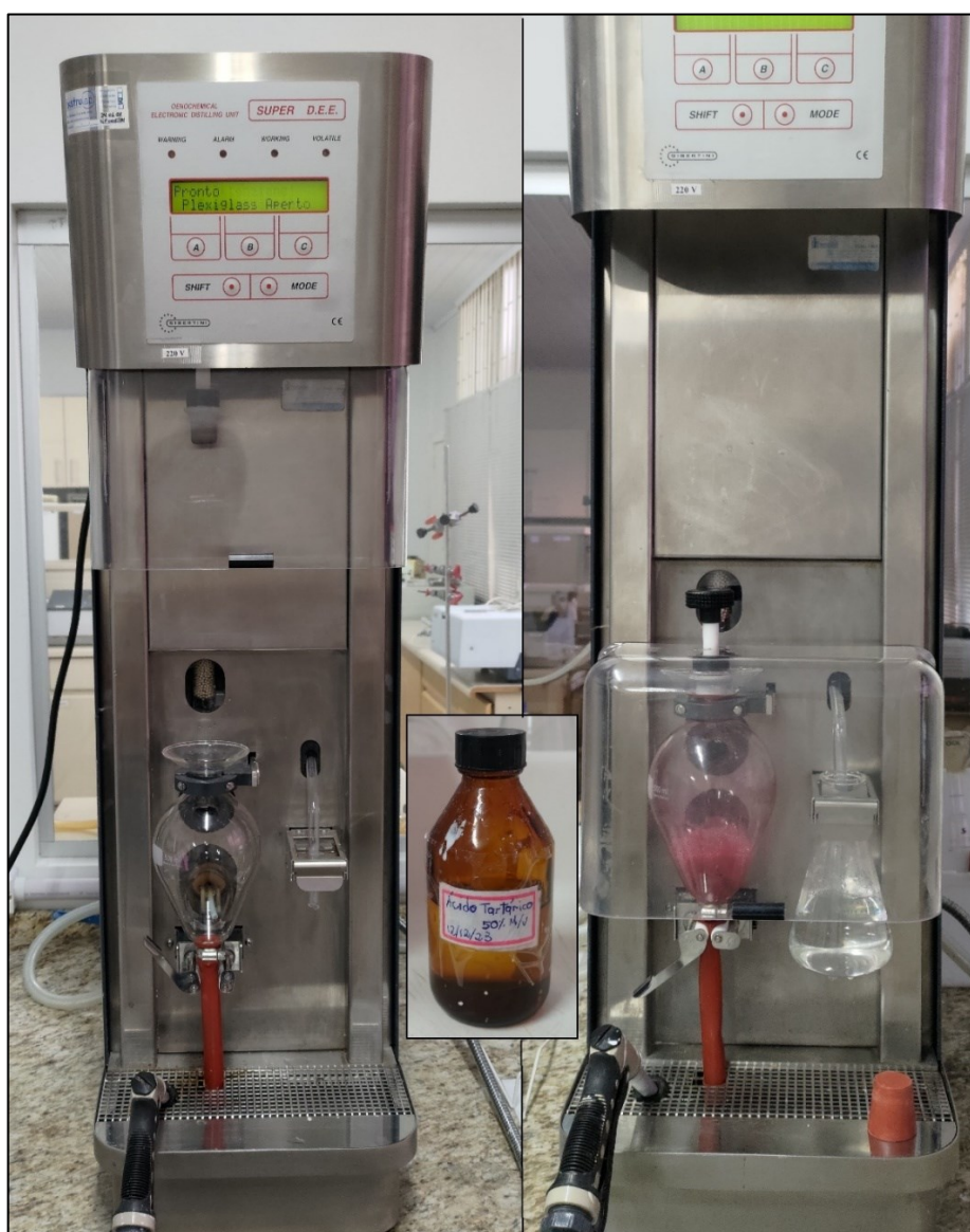
Figura 5: Destilador eletrônico, ácido tartárico a 50% ao meio. Fonte: Acervo do autor (2024)
