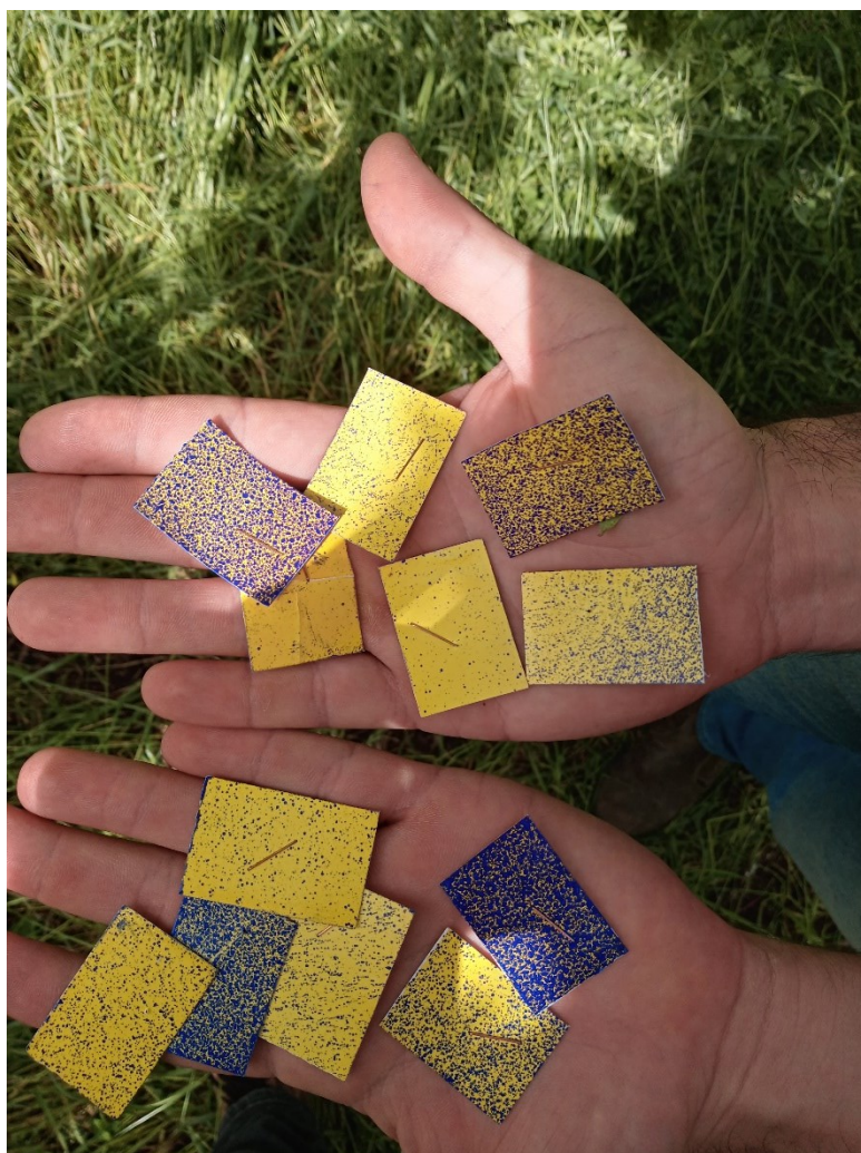
Figura 2 – Cartões hidrosensíveis após a regulagem do pulverizador.
