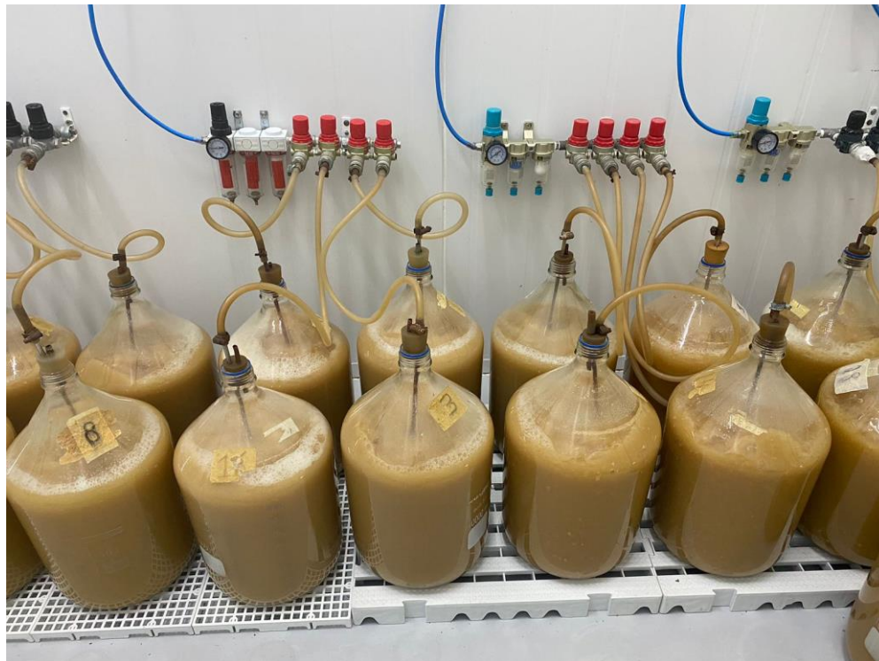
Figura 6 - Recipientes de 10 L em crescimento com injeção de ar
