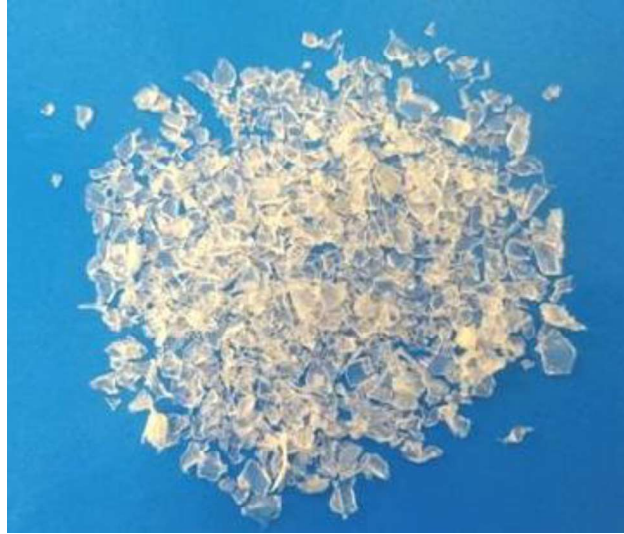
Figura 16 – Partículas de PFA processado resultantes do processo de moagem.
