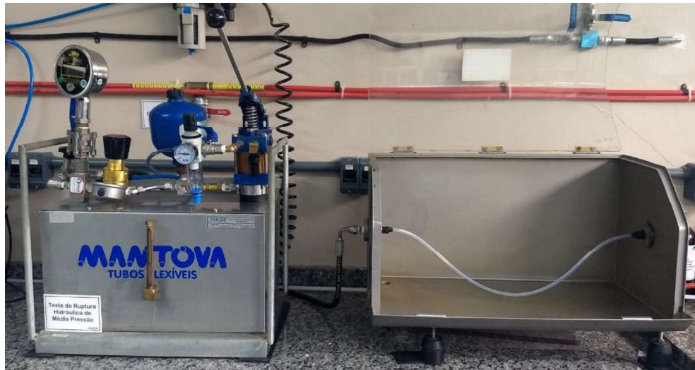
Figura 18 – Máquina de teste de ruptura durante ensaio com a amostra de PFAv.
