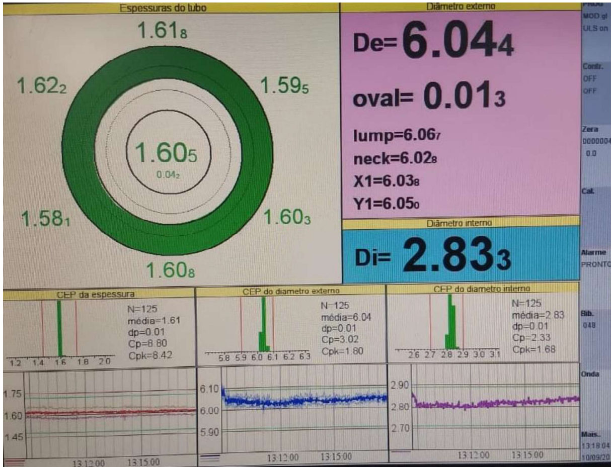
Figura 19 – Resultados de produção apresentados em tempo real na linha de extrusão.
