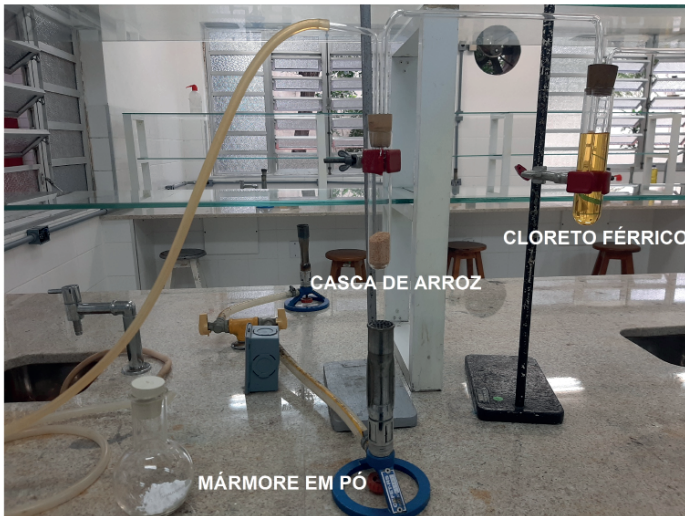
FIGURA 3. Experimento de pirólise da casca de arroz em bancada. Organização dos reagentes (Fig. 3a) e durante reação de pirólise (Fig. 3b).
