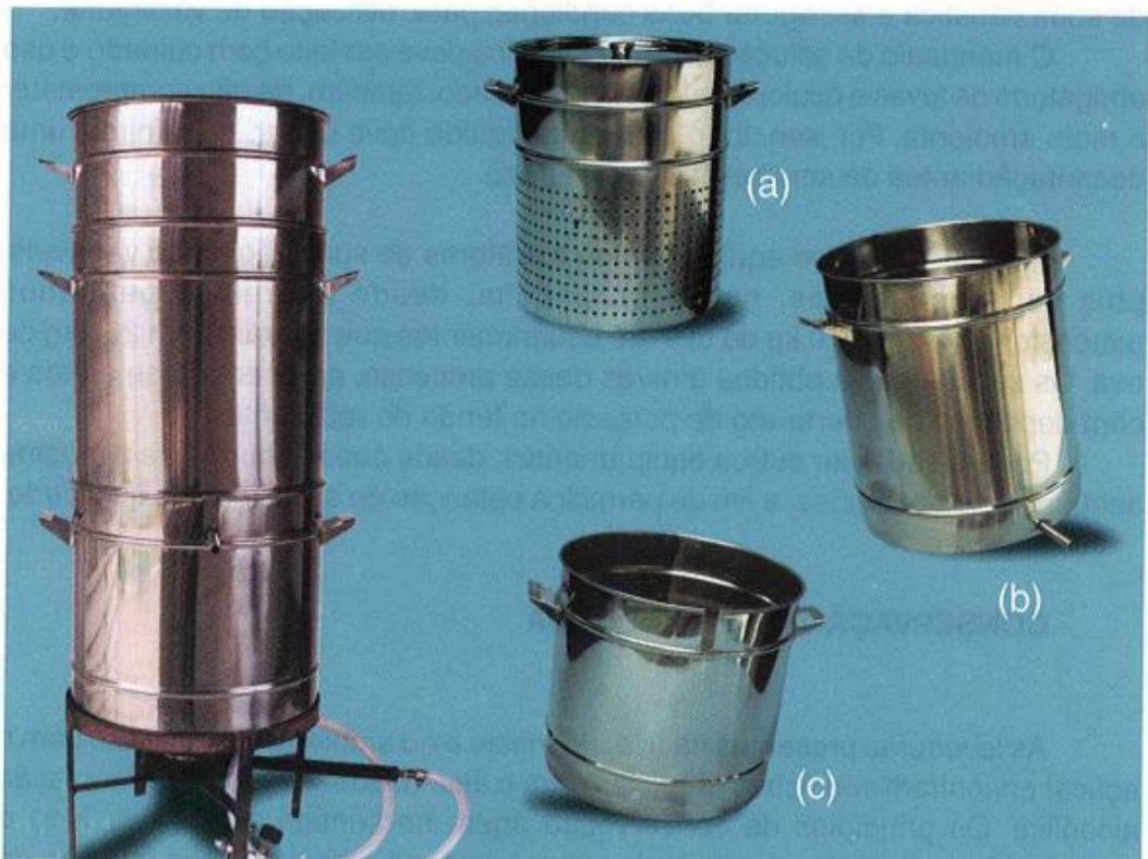
Figura 2 - Extrator de suco, a) recipiente com tampa para colocar a uva; b) recipiente do suco e c) depósito de água.
