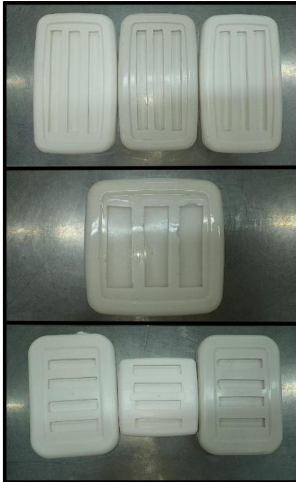
As condições de cura para a resina poliéster foram de 24 h a 25 °C, pós-cura de 6 h a 80 °C e 2 h a 120 °C, definidas de acordo com os melhores resultados obtidos na literatura por Romanzini et al. (2012). A primeira pós-cura ocorreu de modo a evitar eventuais modificações químicas após a cura, e a segunda cura tem como objetivo eliminar a tensão química. A Tabela 1 apresenta uma descrição para a nomenclatura utilizada para a resina e para os compósitos produzidos.
