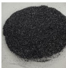
Figura 6 – Cinzas de cascas de arroz da grelha
