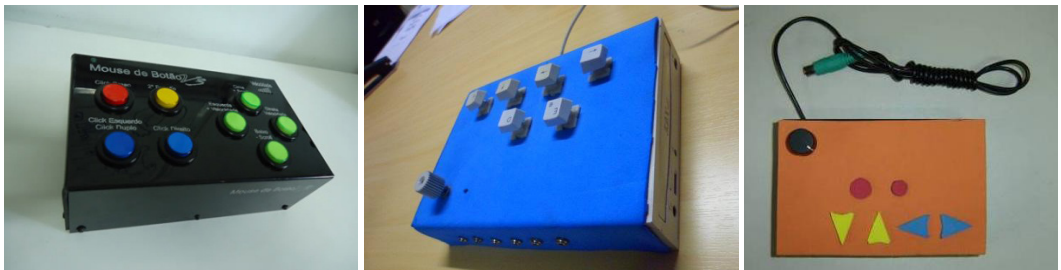
Figura 56 – Diferentes modelos de Mouse de botão Fonte: IFRS – Projeto de Acessibilidade Virtual
