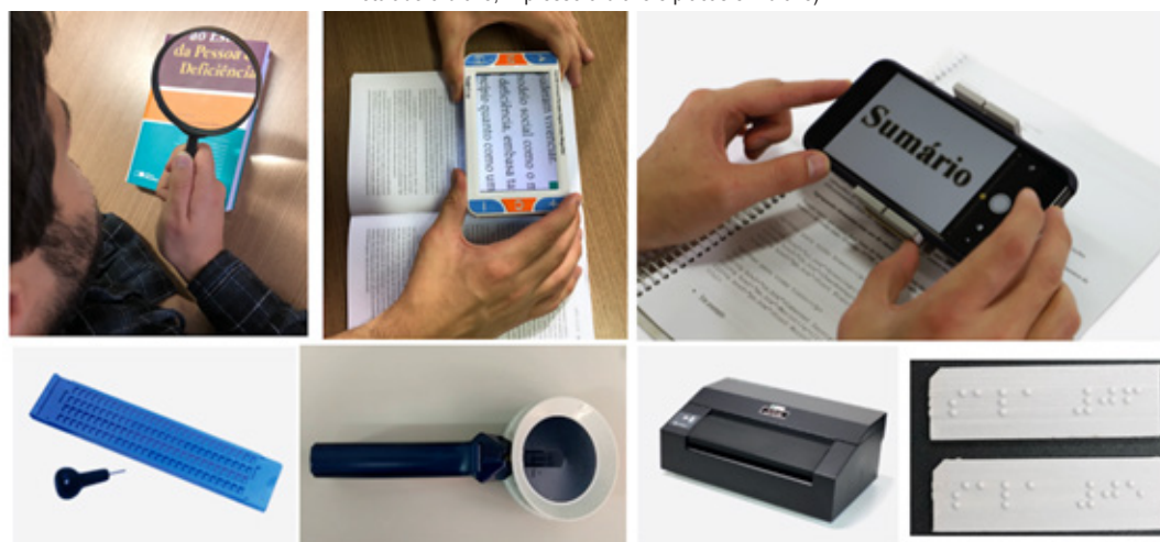
Figura 2 — Exemplos de aplicação de recursos de apoio para a visão (lupa manual, lupa eletrônica, suporte para uso do celular como lupa, reglete e punção, rotuladora braille, impressora braille e placas em braille)
