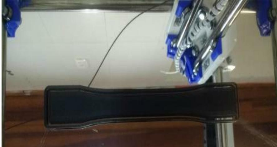
Figura 19 – Impressão do Corpo de Prova. Mesa espelhada reflete parte da estrutura do equipamento.
