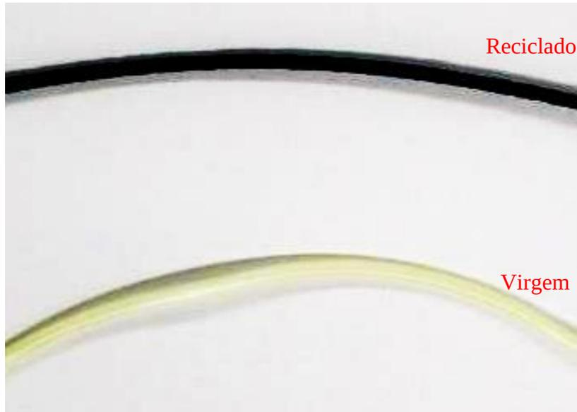
Figura 31 - Comparação filamento reciclado (preto) e filamento comercial (amarelo)
