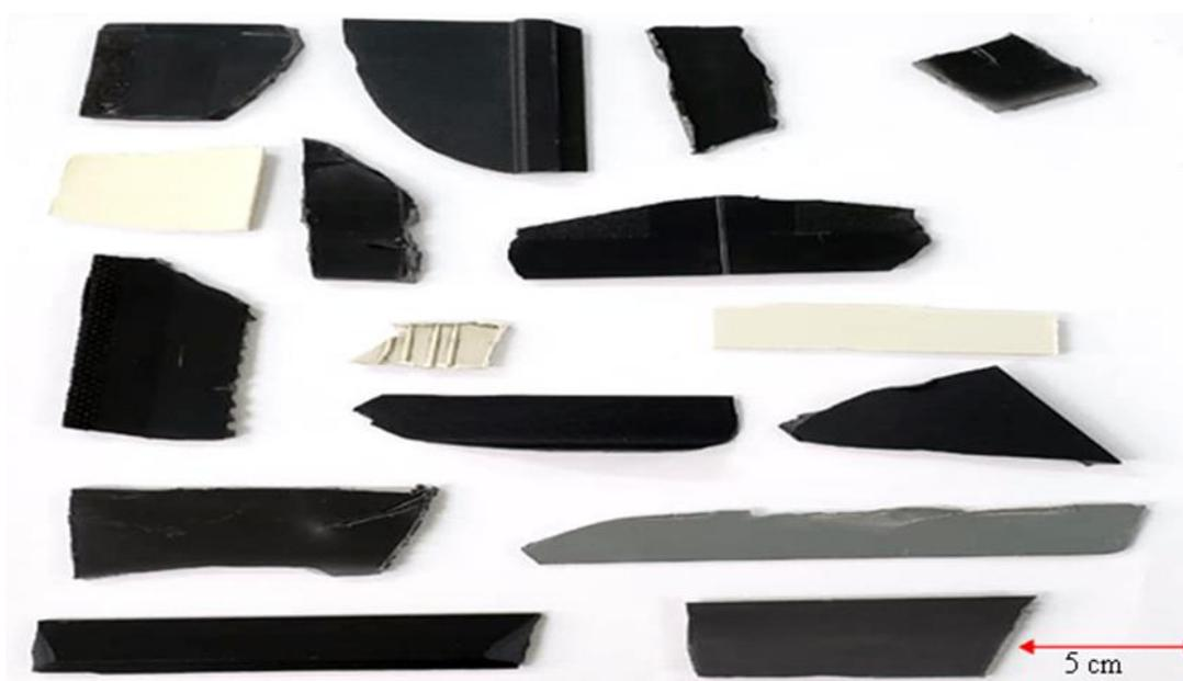
Figura 14 – Fragmentos de peças utilizadas para análise de FTIR.
