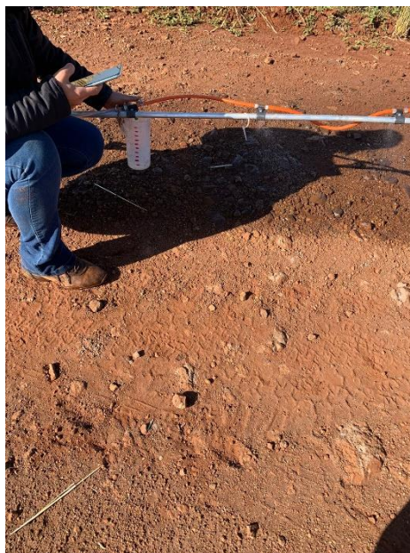
Figura 6: Determinação da vazão da calda. Ibirubá- RS
