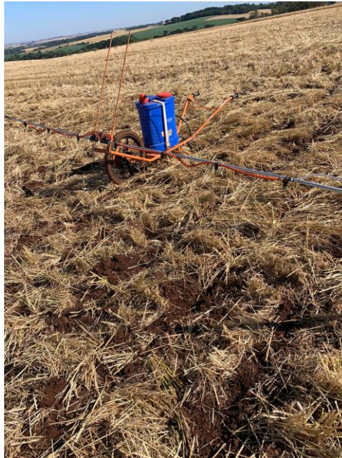
Figura 5: Pulverizador costal adaptado com sistema de barras. Ibirubá – RS.
