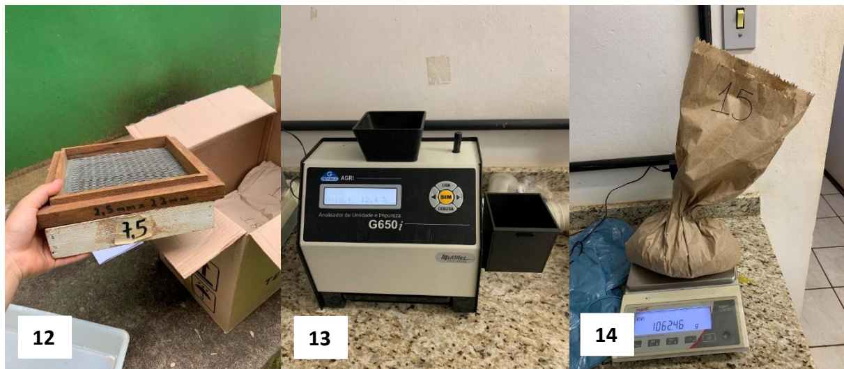
Figura 12,13 e 14: Peneiras utilizadas para a limpeza das amostras após a trilha; Análise de umidade das amostras; Pesagem das amostras utilizando a balança AD2000. Ibirubá – RS.
