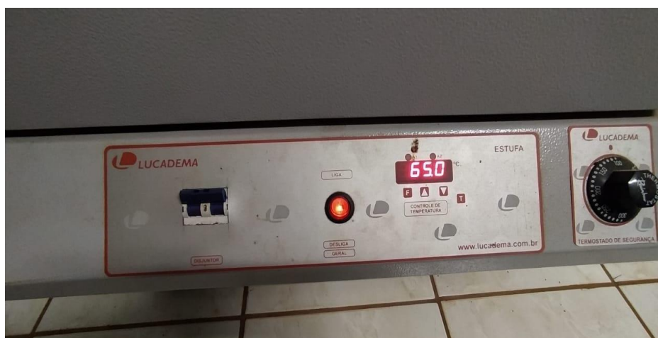
Figura 5. Estufa de circulação forçada a 65° C. Ibirubá, 2022.
