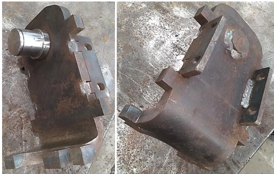
Figura 48 – Corpo lateral soldado.
