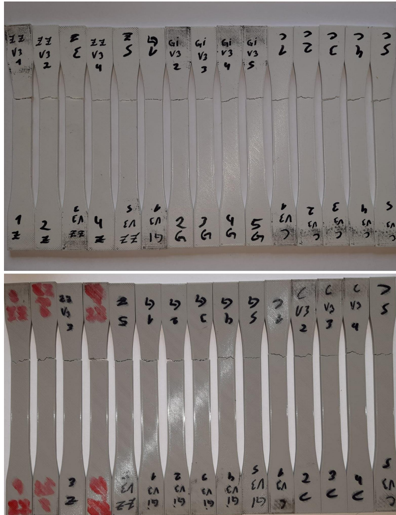
Figura 25: Ruptura dos corpos de prova.
