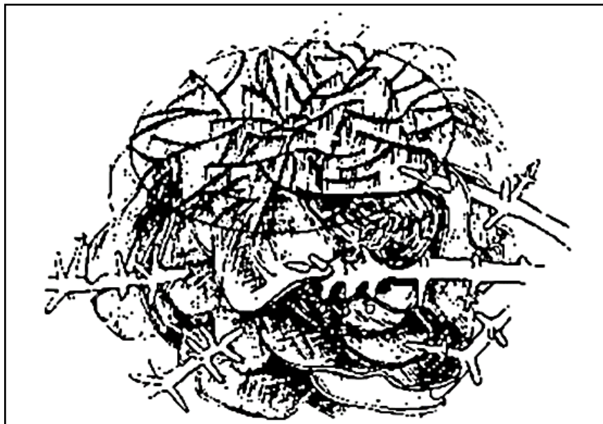
Figura 17 - Dendritas de austenita e célula eutética (grafita + austenita) em ferro fundido cinzento. A grafita é contínua na célula eutética e apresenta a forma de plaquetas.
