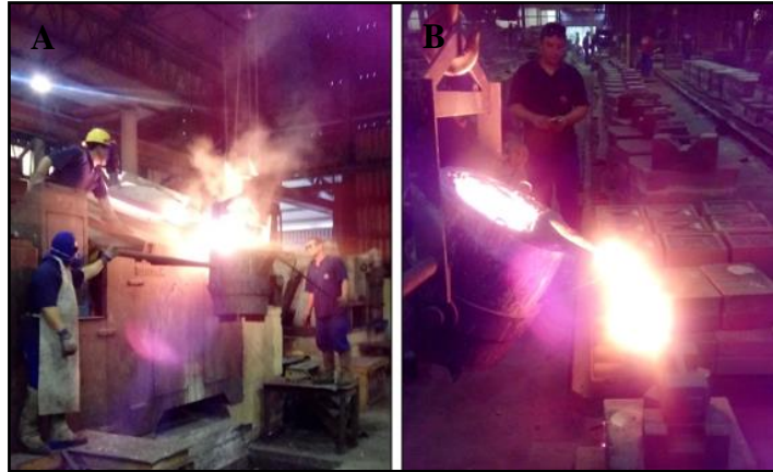
Figura 40 – (A) transferência do metal para a panela de vazamento, (B) vazamento dos CP em GG 25 com Nb.
