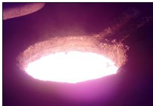
Figura 39 - FeNb dissolvido pelo banho metálico.
