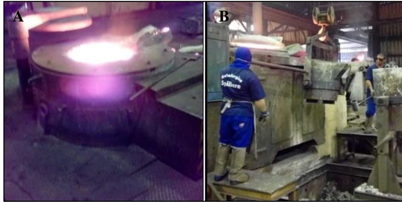
Figura 34 – (A) forno a Indução, (B) panela de vazamento.
