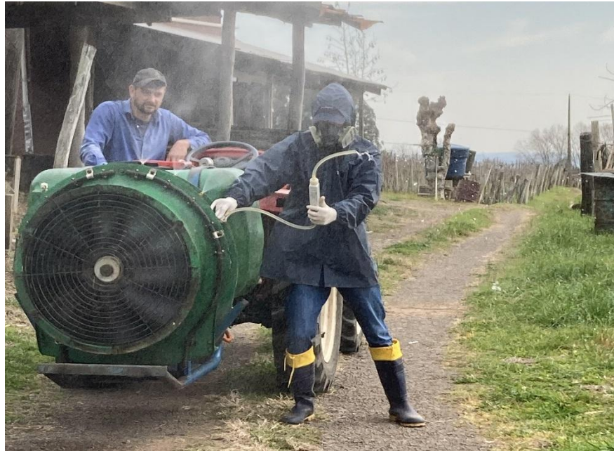
Figura 9: Aferição das pontas de pulverização.
