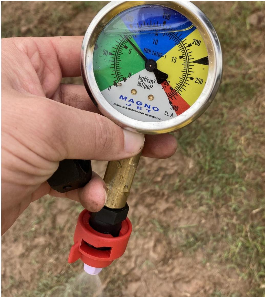
Figura 7: Aferição de pressão com manômetro portátil.
