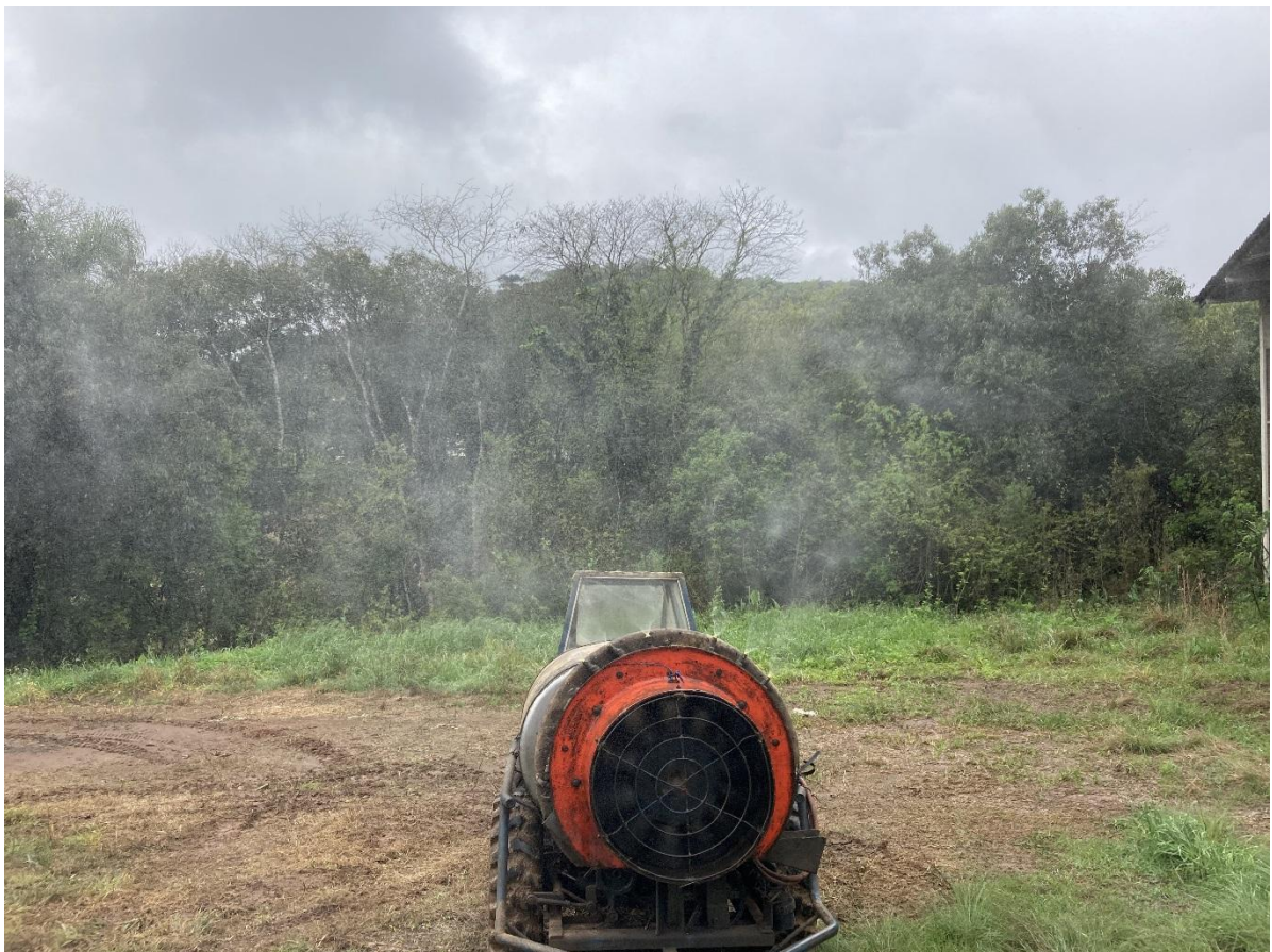
Figura 5: Turboatomizador sendo avaliado visualmente.
