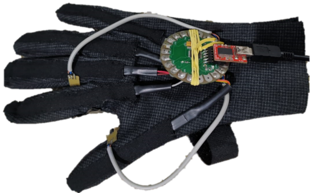
Figura 7. Luva de captação dos sinais dos movimentos de Libras.
