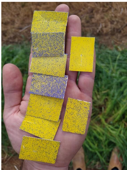
Figura 11 Cartões demonstrando cobertura de gotas com aplicação utilizando pulverizador eletrostático.
