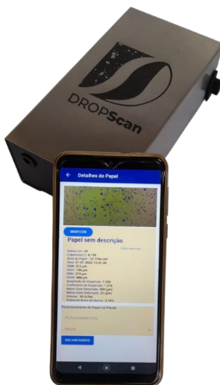
Figura 9 Imagem do scanner dropscan e da tela do aplicativo para celular.
