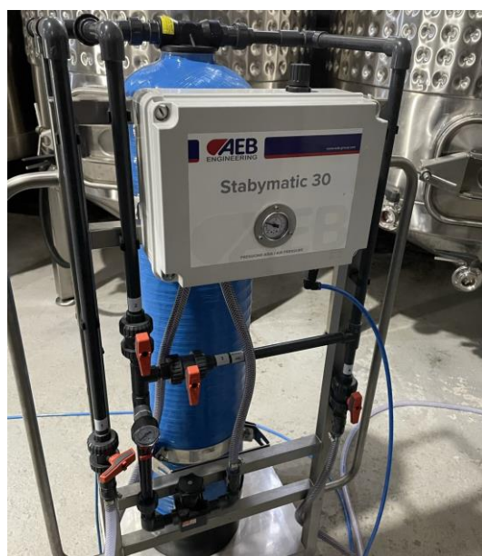
Figura 2: Troca de pH com resina iônica
