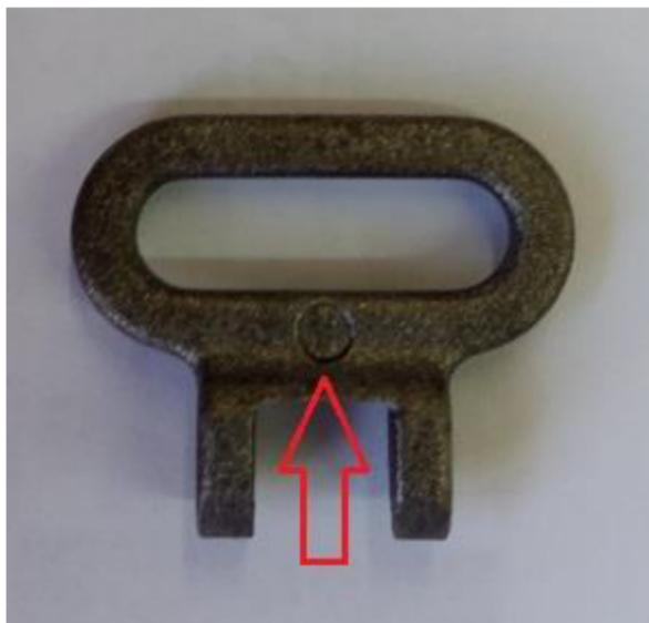
**Figura 3.1. Peça com marca do pino de extração.**
