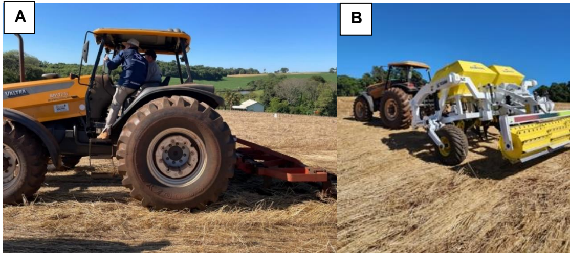
Figura 6: Manejo de solo com subsolador convencional (A) e manejo de solo com descompactador rotativo com rolo faca Vollverini (B)
