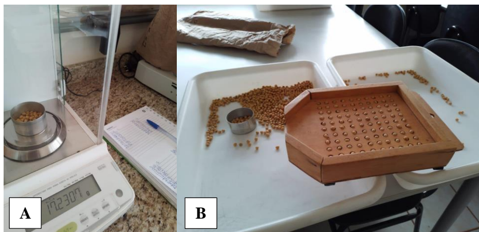
Figura 16: Pesagem da massa de 100 grãos (A) e contagem da massa de 100 grãos (B)
