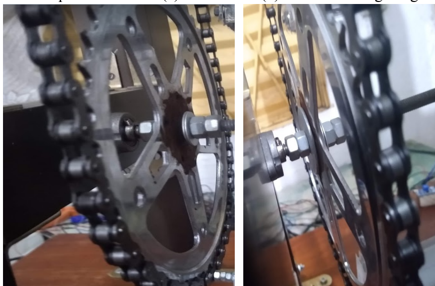
Figura 53: Contra-porcas traseiras (a) e dianteiras (b) de uma das engrenagens inferiores.
