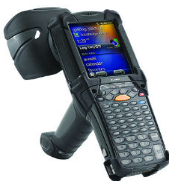
Figura 13: Modelo de leitor RFID manual.
