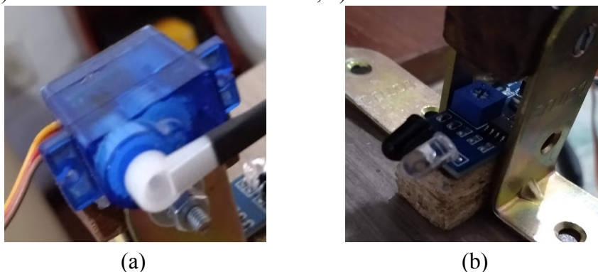
Figura 63: a) Servo motor instalado na cancela; b) sensor de obstáculo instalado na cancela.
