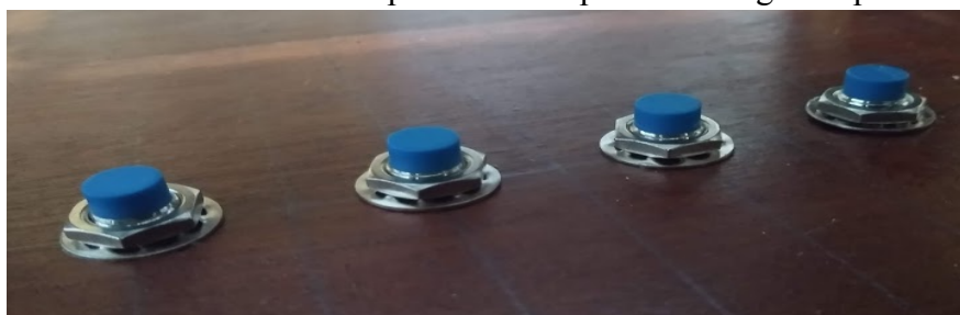
Figura 57: Sensores indutivos posicionados para cada vaga nas plataformas.
