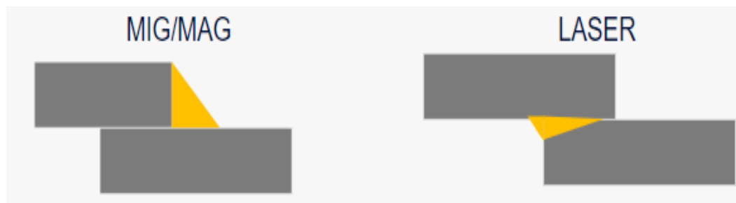
Figura 12 - Ilustração das geometrias de cordões dos processos MIG/MAG e a LASER.
