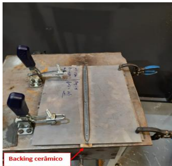
Figura 26 - Forma de fixação dos corpos de prova (junta de topo).
