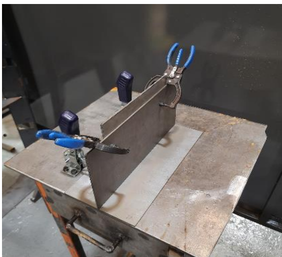
Figura 27 - Forma de fixação para soldagem dos corpos de prova (junta de ângulo).
