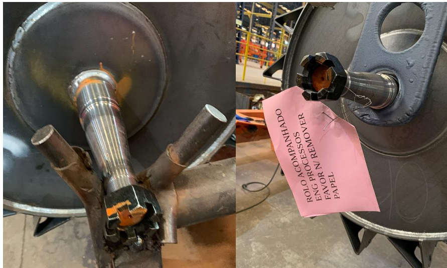
Figura 21: Conjunto demarcado após solda e jateamento
