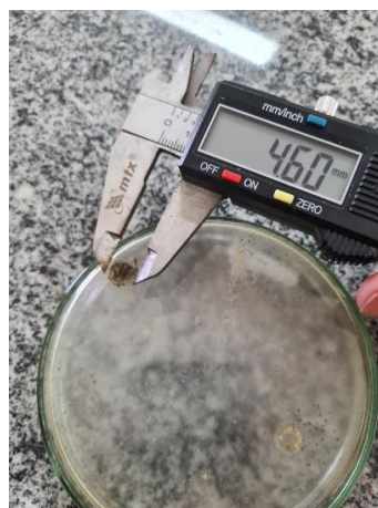
Figura 6 – Medida de diâmetro do disco dos isolados (mm) no teste de confronto direto.
