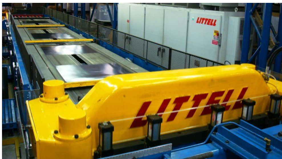
Figura 4 – Linha de corte de chapas (Cinbal, 2024)
